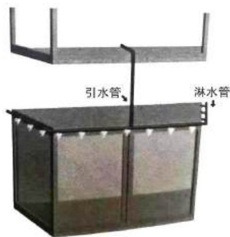
图 C.0.2 外门窗（墙）淋水示意图
